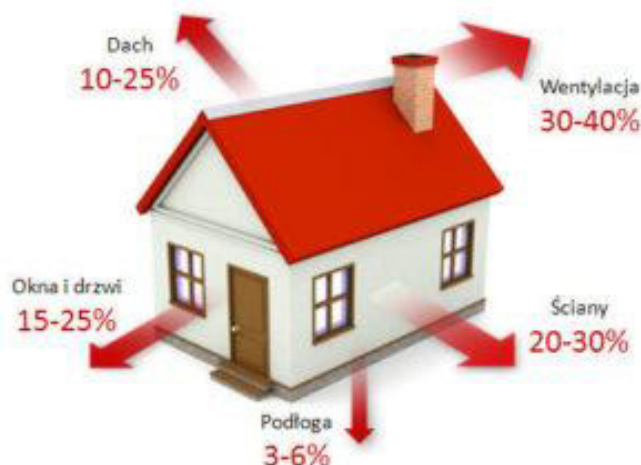
Rysunek 21. Procentowa strata ciepła w budynku 15
